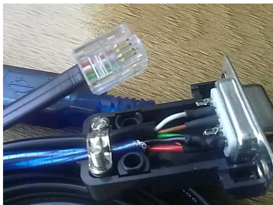
Cable para conectar a puerto serie nativo. El hilo rojo y el negro del cable azul son para la alimentación.
